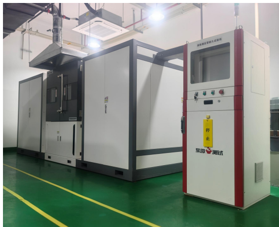
涡轮增压管脉冲试验台
